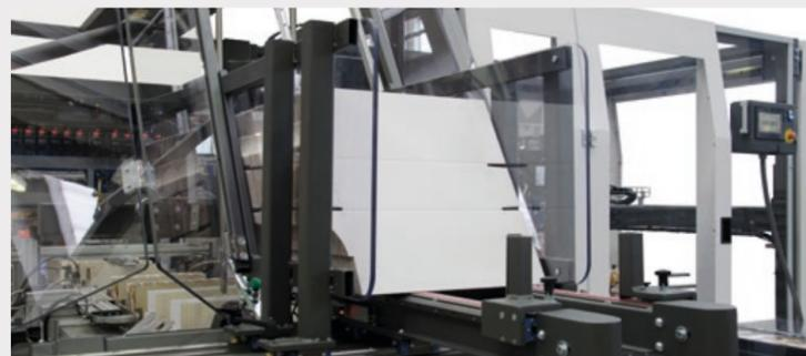
Almacén de cajas regulable por el utilizo con cajas de diferentes tamaños. Rápido y fácil cambio de formato.
