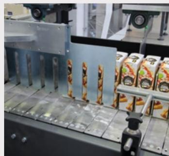
El sistema de empuje automático permite que los productos se recojan en multipacks o en singulo.
