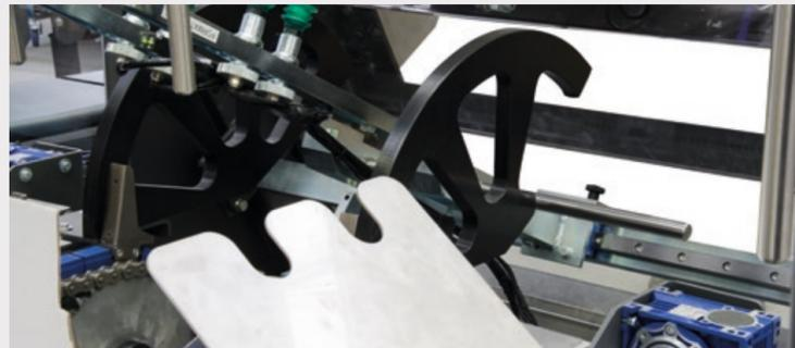
Las estaciones de carga y apertura de la caja están montadas sobre guías lineales deslizantes para una mayor accesibilidad durante las operaciones de mantenimiento.
