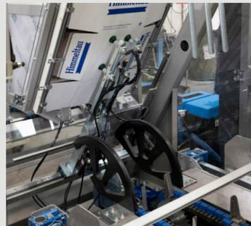
Sichere und zuverlässige Entnahme der Kartons aus dem großen Lager mit einem System aus Saugnapfen.
