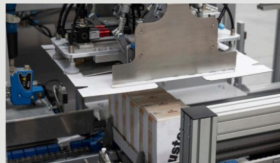
Möglichkeit verschiedene Verpackungsarten mit derselben Maschine herzustellen: Wrap-Around-Packer, Boden + Deckel, Tray, Zweites Kartonlager für die Deckelanbringung.
