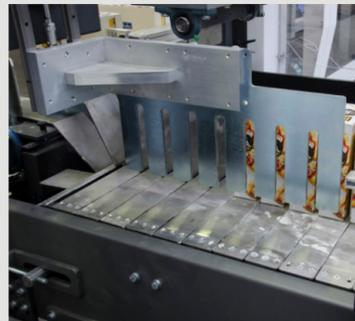
Der automatische Schieber ermöglicht den Produkten, dass sie gruppiert und mit Präzision in der Tray/den Karton abgegeben werden.
