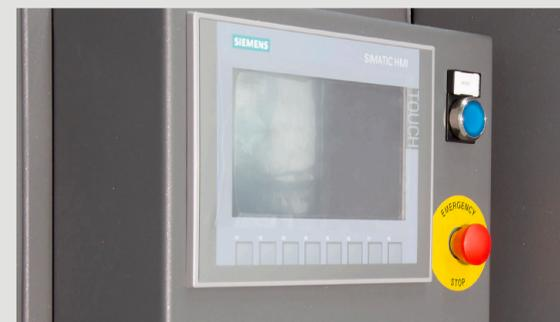
SIEMENS oder OMRON Touchscreen für eine intuitive und einfache Bedieneranwendung.
