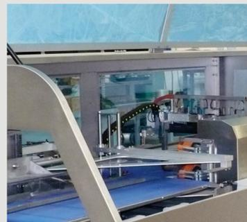
Máquina envasadora de soldadura lateral para formar la bolsa. Soldaduras estancas.
