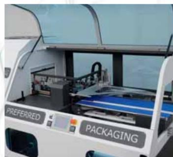
La barra unica verticale, che garantisce la stessa pressione su tutti i punti del film, sostituisce la vecchia barra a forbice per una saldatura uniforme.
