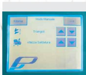
Facili cambi formato: centro di saldatura e triangolo motorizzato. Altezza fino a 400 mm.
