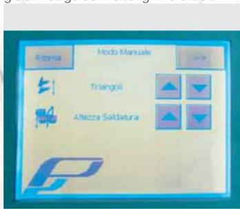
Einfacher Formatwechsel: Mittelschweißung und motorbetriebene Formschulter, Höhe bis zu 400 mm bei der größeren 790CS-Version. Siemens-Touchscreen. Einfaches Einstellen.
