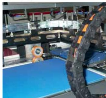
Schweißstempelbreite nur 1 cm, vertikale Bewegung und kein Scherensystem, einheitliches Schweißergebnis, geringer Folienverbrauch, niedrigere Schrumpfkosten.
