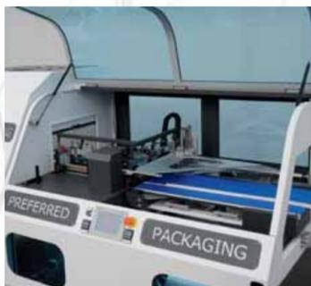
Der vertikale Schweißstempel in L-Form sorgt dafür, dass derselbe Druck auf die zu schweißende Folie ausgeübt wird und ersetzt so das alte Scherensystem. Eine gleichmäßige Schweißung wird erzielt.
