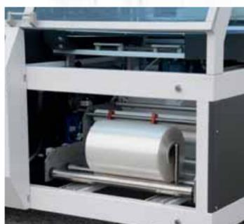
Folienlager und Einheit für die Folienabfallaufwicklung befinden sich beide vorne an der Maschine und sind somit leicht zugänglich. Schiebetür.
