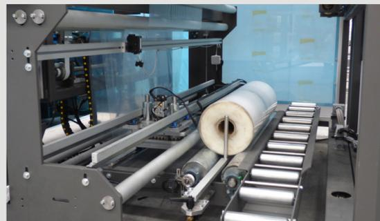
En voladizo y accesible desde los dos lados. Portabobina con carro para carga y sustitución más fáciles.
