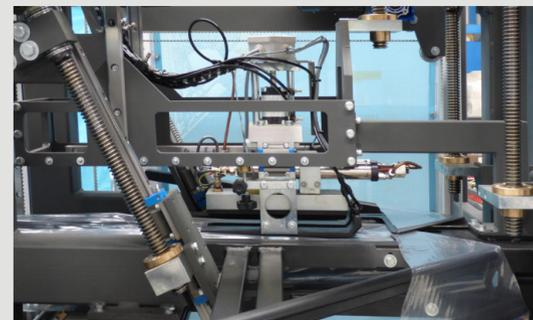
Tubo formador fijo, diseñado según las dimensiones reales del producto. Programas recuperables según la receta.
