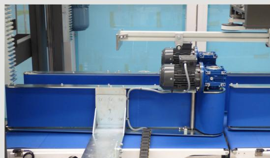
Dispositivo de empuje motorizado con control de velocidad para un mayor rendimiento.
