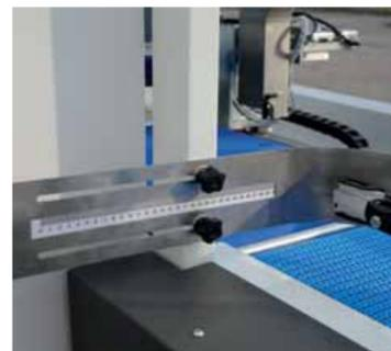
Schneller Formatwechsel, Größen an metrischer Skala angegeben.
