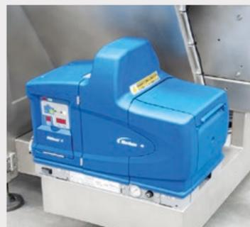
Fusor de cola Hot Melt para el cierre de los extremos inferiores Meler, Nordson o Noxon, a petición del cliente.
