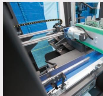
Magazzino cartoni riempibile con macchine in funzione in posizione ergonomica ed accessibile per il carico e facile cambio formato
