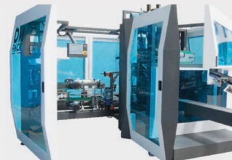
Quadro elettrico in posizione alta accessibile e visibile attraverso un lexan trasparente
