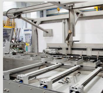
Motorbetriebene Schieberreihe, die das genaue, kontinuierliche Einsetzen des Produkts in den Karton erlauben.
