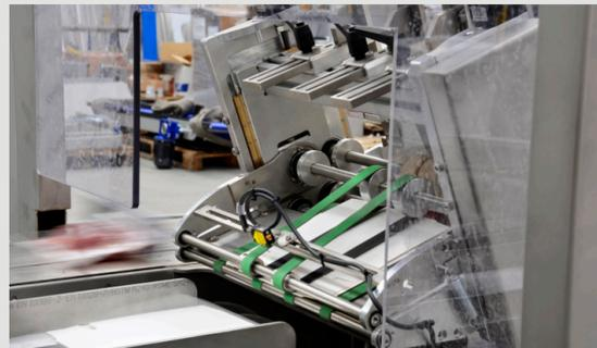
Präzises und wirksames Auswurfsystem der Kartons vom Lager in der kontinuierlich arbeitenden Ausführung oder über motorbetriebenen Arm mit Saugnapfen in der intermittierenden Ausführung
