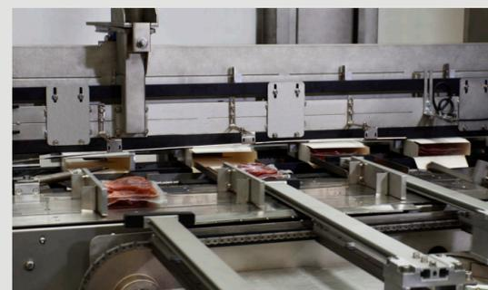
Mechanisches Öffnen der Klappen, obere Riemen, die einen sicheren und stabilen Transport des Kartons zur Ausgangsstation ermöglichen
