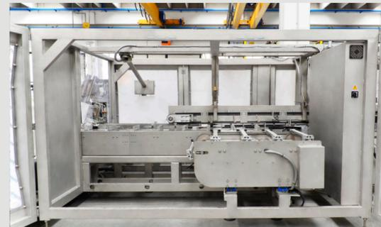
Komplett, an jeder Stelle zugängliche auskragende Konstruktion für eine einfache und schnelle Wartung und Reinigung. Optimale Konstruktion unter gesundheitlichen und hygienischen Aspekten.
