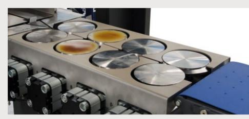
Quatre paires de roues pour souder et plier. Diamètre min. roues 120 mm
