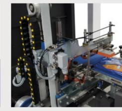
Barre de soudage motorisée avec système de réalisation de soufflets.
