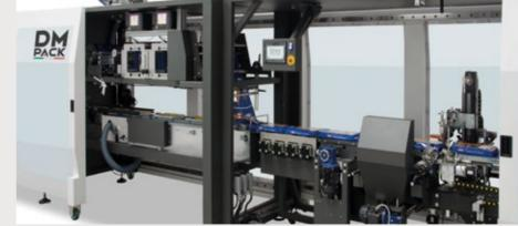
Structure en porte-à-faux facilement accessible, parfaite pour l'entretien et le nettoyage. Différents systèmes d'ouverture (portes à charnières standard, coulissantes en option), sur les deux côtés si besoin.
