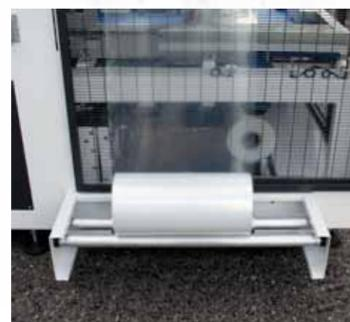
Entrambe le bobine in basso per agevolare la sostituzione
