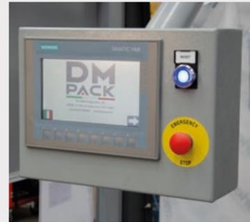
Touch screen per comodo interfaccia dell'operatore nella lettura e programmazione dei parametri macchina. Capacità di memorizzare fino a 25 programmi diversi.
