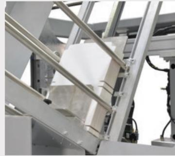
Ampio magazzino fustelle regolabile
