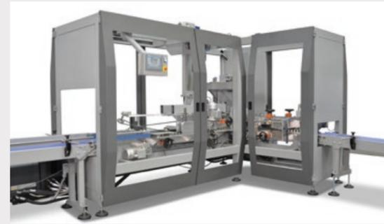
Stazione di chiusura astuccio separata nel caso in cui il riempimento venga effettuato manualmente da un operatore.
