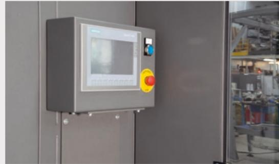
Máquina gestionada por PLC Siemens u OMRON y pantalla táctil intuitiva. Cambio de formato ajustable fácilmente desde panel.
