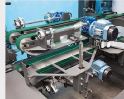
Cierre automático de la caja con cinta adhesiva o cola a alta temperatura como opcional. Guías laterales motorizadas. Ajuste automático.
