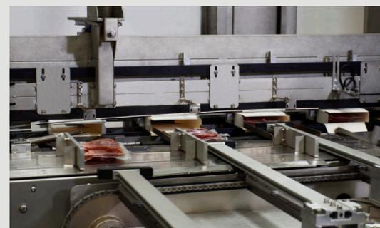
Fila di Spintori motorizzati che permettono il preciso inserimento in continuo del prodotto all'interno dell'astuccio
