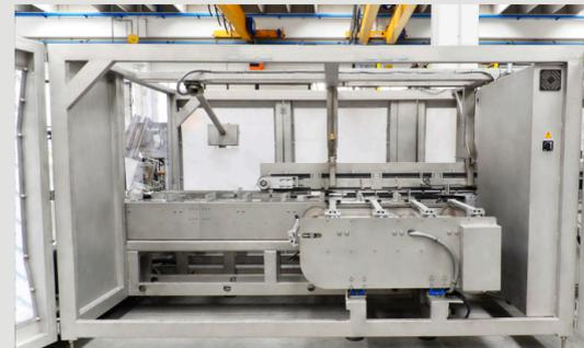
Apertura patte meccanica, cinghie superiori che permettono un sicuro e stabile trasporto dell'astuccio verso la stazione d'uscita
