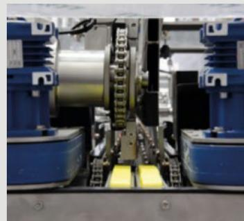
Cinghie laterali motorizzate che assicurano stabilità del prodotto in uscita anche ad alte velocità
