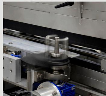
Preciso ed efficace sistema a rilascio degli astucci dal magazzino, nella versione continua, o tramite braccio motorizzato equipaggiato da ventose nella versione intermittente
