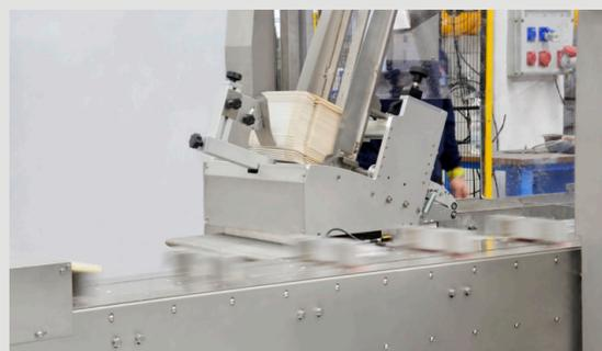
Struttura a sbalzo completamente accessibile in tutte le sue parti, per manutenzione e pulizia facili e rapide. Costruzione igienico sanitaria ottimale
