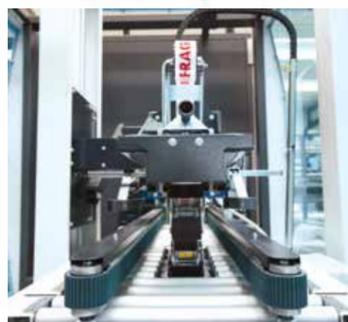
Stazione di uscita con cinghie guida regolabili a seconda della misura del cartone.
