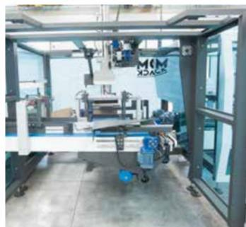
Completamente accessibile e apribile. Gruppo di carico e cartonamento separabili per permettere l'accesso dell'operatore per una facile manutenzione.
