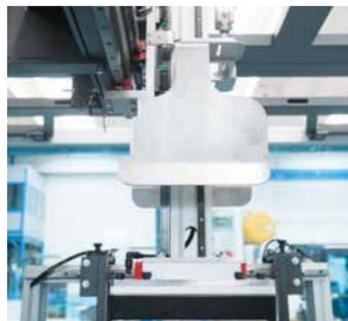
Pick & place per una veloce e accurata presa dei prodotti in arrivo dal nastro trasportatore di carico e un preciso riempimento.
