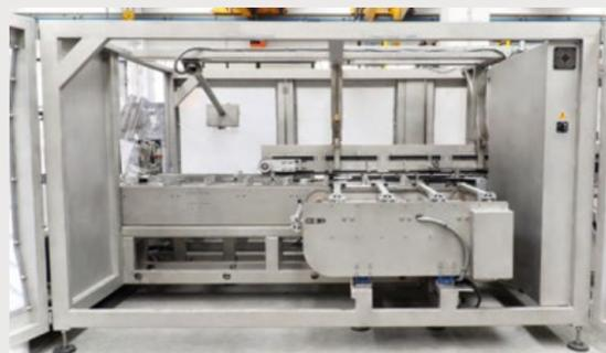
Struttura a sbalzo completamente accessibile in tutte le sue parti, per manutenzione e pulizia facili e rapide. Costruzione igienica sanitaria ottimale
